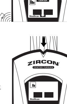
Bei tiefer in dickeren Wänden gelegenen Balken wird die Mitte des gefundenen Balkens mit nur ein oder zwei Säulen auf dem Signalstärkenanzeiger angezeigt, und nur die mittleren Segmente der Zielanzeigesäulen leuchten auf. Falls Sie danach weiterhin keinen Balken orten können, stellen Sie bitte auf DeepScan® um.
