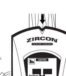
Fahren Sie entlang der Oberfläche mit dem Scannen fort. Wenn die Balkenmitte ermittelt wurde, leuchten die drei Säulen auf dem Signalstärkenanzeiger, die mittleren Segmente der Zielanzeigesäulen und die MITTE-Anzeige sowie der SpotLite®-Zeiger auf, und es ertönt ein Signaltion.
