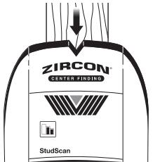
Om regeln ligger djupt (eller om ytmaterialalet är tjockt), kommer bara två staplar i signalstyrkeindikatorn, de mittersta staplarna i målindikatorn och SpotLite®-markören att tändas upp för att visa regelnens mittpunkt. Om ingen regel kan detekteras, prova DeepScan®-läget.
