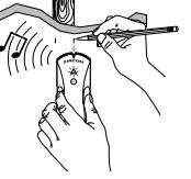
**Tapetti:** StudSensor™ EDGE -laite toimii normaalista tapetilla tai kankaalla päälystettyillä seinillä, ellei pinta materiaali ole metallikalvoa. Materiaali ei myöskään saa sisältää metallikuituja tai olla märkä.
